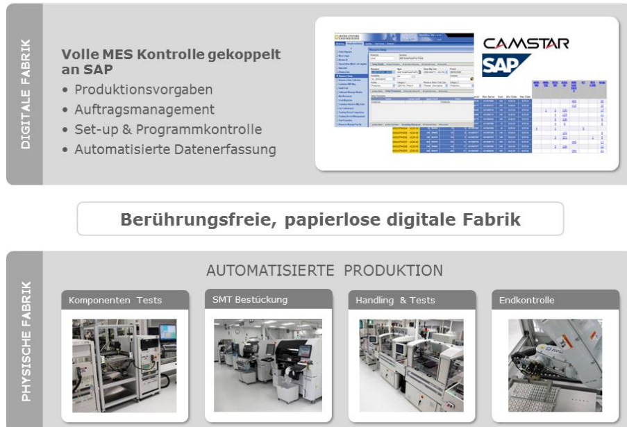
Abbildung 3: Eine prognostische, schnelle Beseitigung von Anomalien erfordert minimale Eingriffe während der Montage/Prüfung sowie Echtzeit-Zugriff auf parametrische Qualitätsdaten, Rückverfolgbarkeit und Transaktionsinformationen. Die digitale und physische Fabrik von MSEI bietet dies in Verbindung mit strengen Prozesskontrollen, einer «berührungslosen» Produktpolitik und einer parametrischen Erkennung anormaler Verhaltensweisen.
